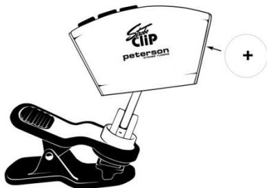
Le SC-1 fonctionne avec une pile bouton CR2032. Pour l'installer, retournez l'accordeur de manière à voir le dos, retirez le socle de la pile du côté droit, insérez la pile dans son socle, côté + vers le haut. Glissez à nouveau le compartiment dans l'accordeur. Une icône pile s'affiche lorsque la pile est presque usée.
